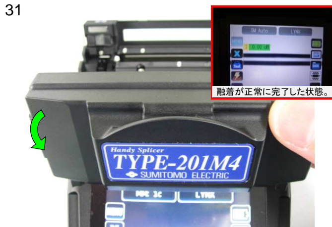
31 融着接続後に、融着機の風防を開けるとプルーフテストを行います。トンという電子音が鳴るとプルーフテスト完了です。
