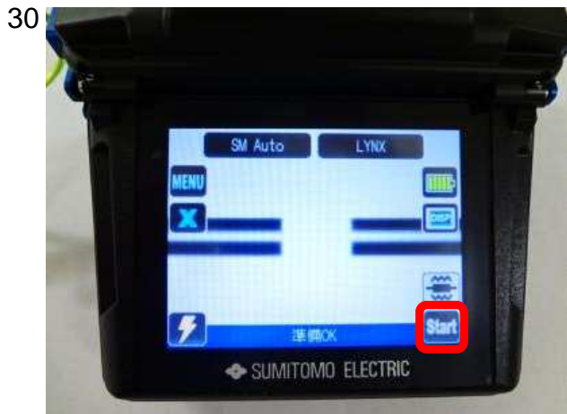
30 Start アイコンを押すと融着動作を開始します。 (オートスタート設定の場合、融着動作を自動で開始します。 詳細な操作方法は各融着機の取扱説明書をご参照ください)
