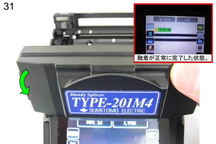
31 融着接続後に、融着機の風防を開けるとブルーフェストを行います。 トンという電子音が鳴るとブルーフェスト完了です。
