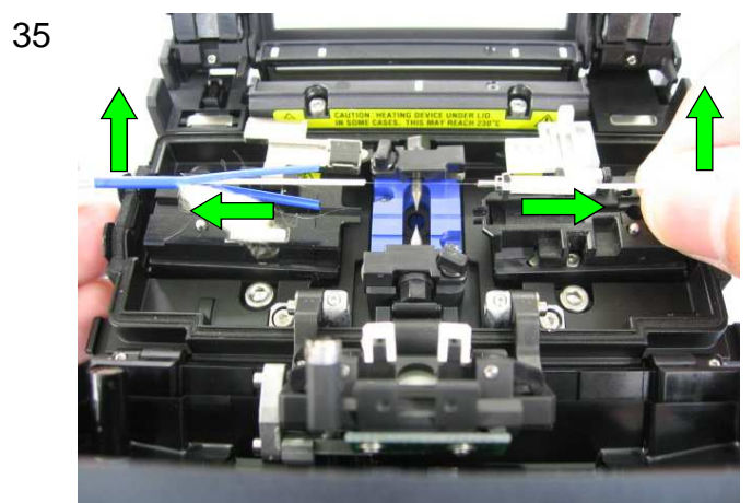
35 コードとダストキャップのヒモを持って、 左右方向に軽く引っ張りながら持ち上げる。
